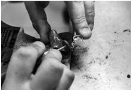
Der beim manuellen Polieren entstehende Staub gefährdet die Gesundheit.
